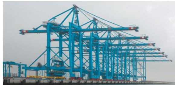
在位于鹿特丹的APMT Maasvlakte II码头，卡尔玛交付了八台全球首个采用远程操控的超大型“EEE”单箱型梁起重机和两艘驳船码头起重机。
